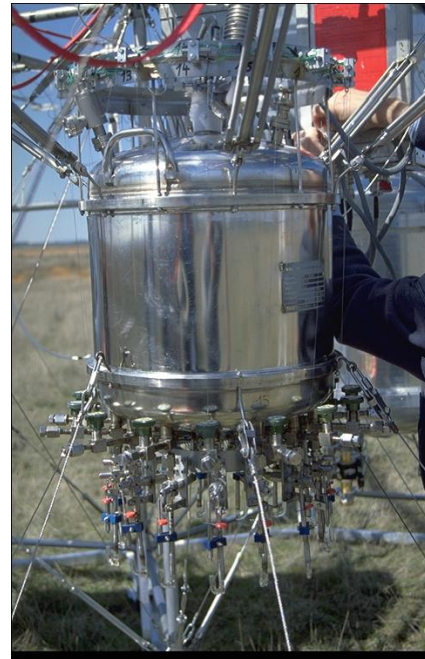
Abbildung 3.2: Links: Stratosphärenballon kurz vor einem Start. Rechts: Kryogener Luftprobensammler.
