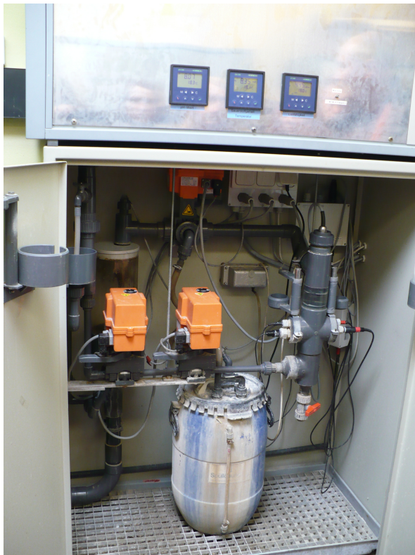
Abbildung 3.6: Untersuchungsapparatur für das Rheinwasser auf pH-Wert, Sauerstoffgehalt, Temperatur und elektrische Leitfähigkeit.
